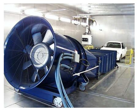
IGW-Fahrtwindlüfter für Klimakammer Institute for Applied Automotive Research (IDIADA) Größe 1400, 120.000 m³/h, 1400 Pa, 75 kW.
