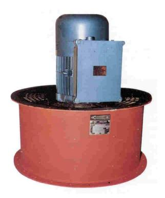
Axialventilator, Bauform D, Baugröße 800, Wanddicke 10 mm, mit Funkenstreifschutz im Laufradbereich, Motor EEx de, Ansaugschutzgitter, Luftmenge 30.000 m³/h, Antriebsleistung 20,0 kW.
